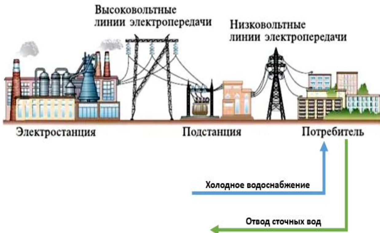
Рисунок 5 – Схема поступления электроэнергии от ТЭС до потребителя
